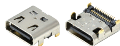
533 USB Type Cレセプタクル (デュアルSMT トップマウント)・CH=1.68mm ピン数:24
