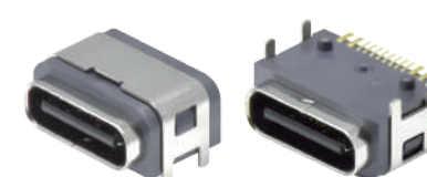
533 防水USB Type Cレセプタクル (30u"金) CH=2.28mm ピン数:16
